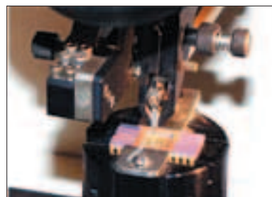
Микрозондирование чипа, извлеченного из смарт-карты
