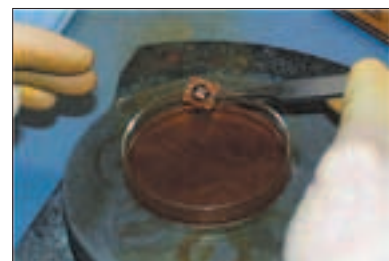
Обработка чипа концентрированной азотной кислотой
